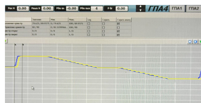
Рис. 2. Точность позиционирования клапана электроприводом «РэмТЭК»
